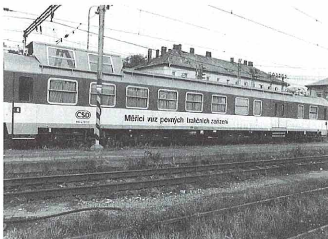
Obr.3 Měřicí vůz pevných trakčních zařízení
